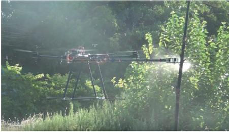
图10 切割状态下的树障清理空中机器人
