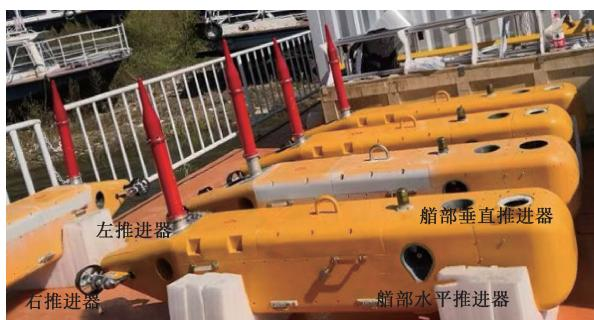
图4 试验用多个AUV图片
