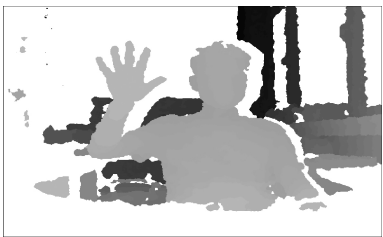
图 2 未经滤波的深度信息图 Fig.2 Unfiltered depth image
